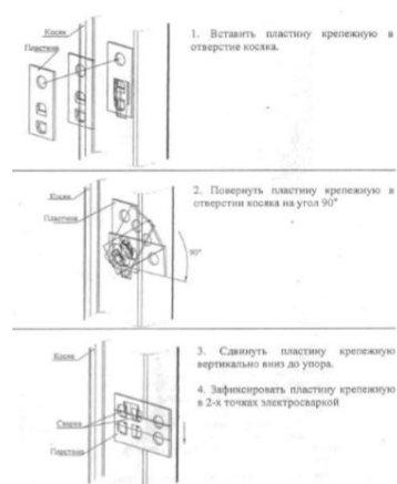
Рис.2 Схема установки пластин крепежных
